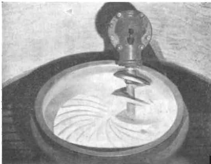
Fig. 1. - L'impastatrice per il petrinaggio della nitroglicerina in funzione.
